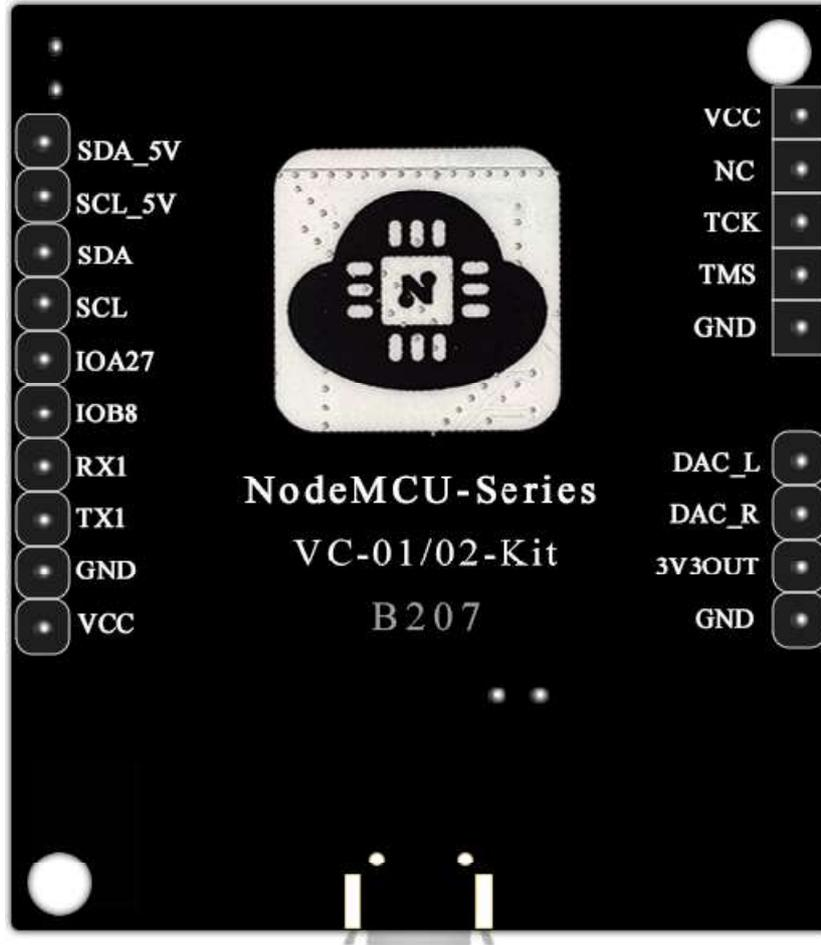
图 6 开发板管脚示意图（底部视图）
