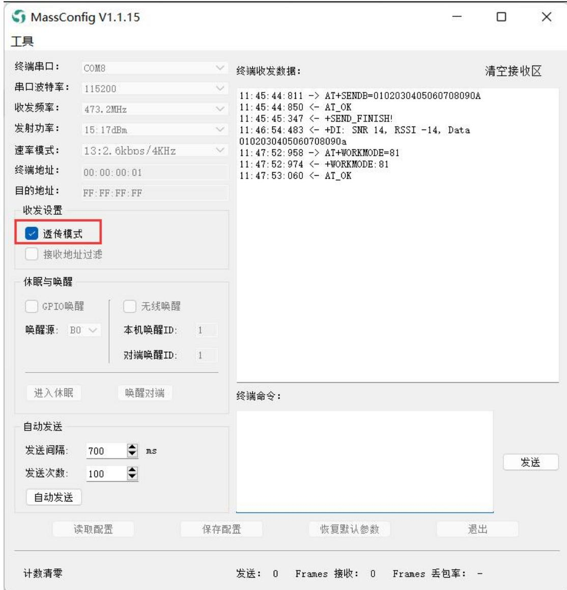
图 2-5 透传模式测试-终端 A 配置界面
