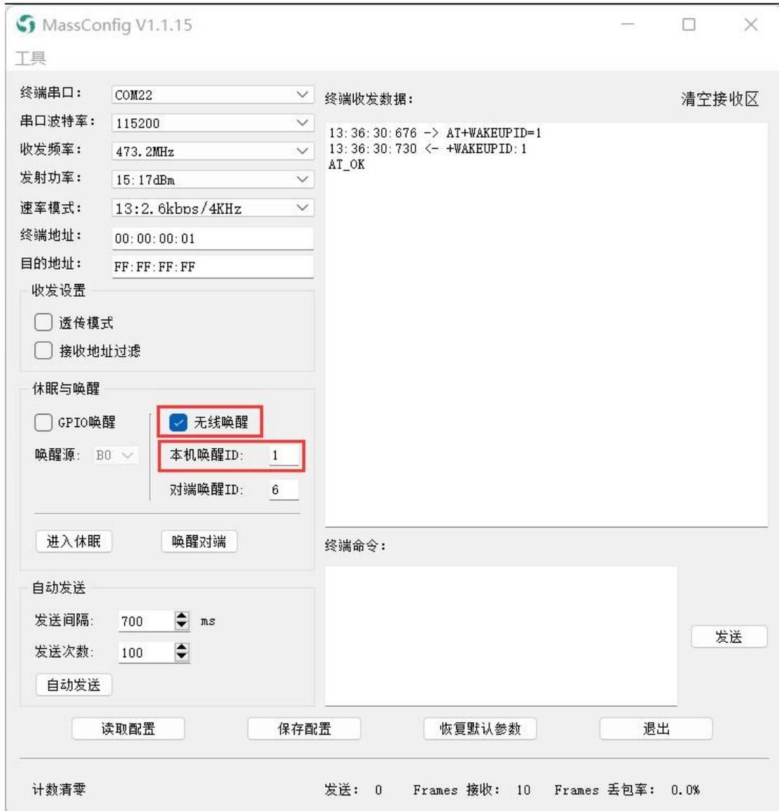
图 2-22 主动唤醒测试-终端 B 无线唤醒参数设置
