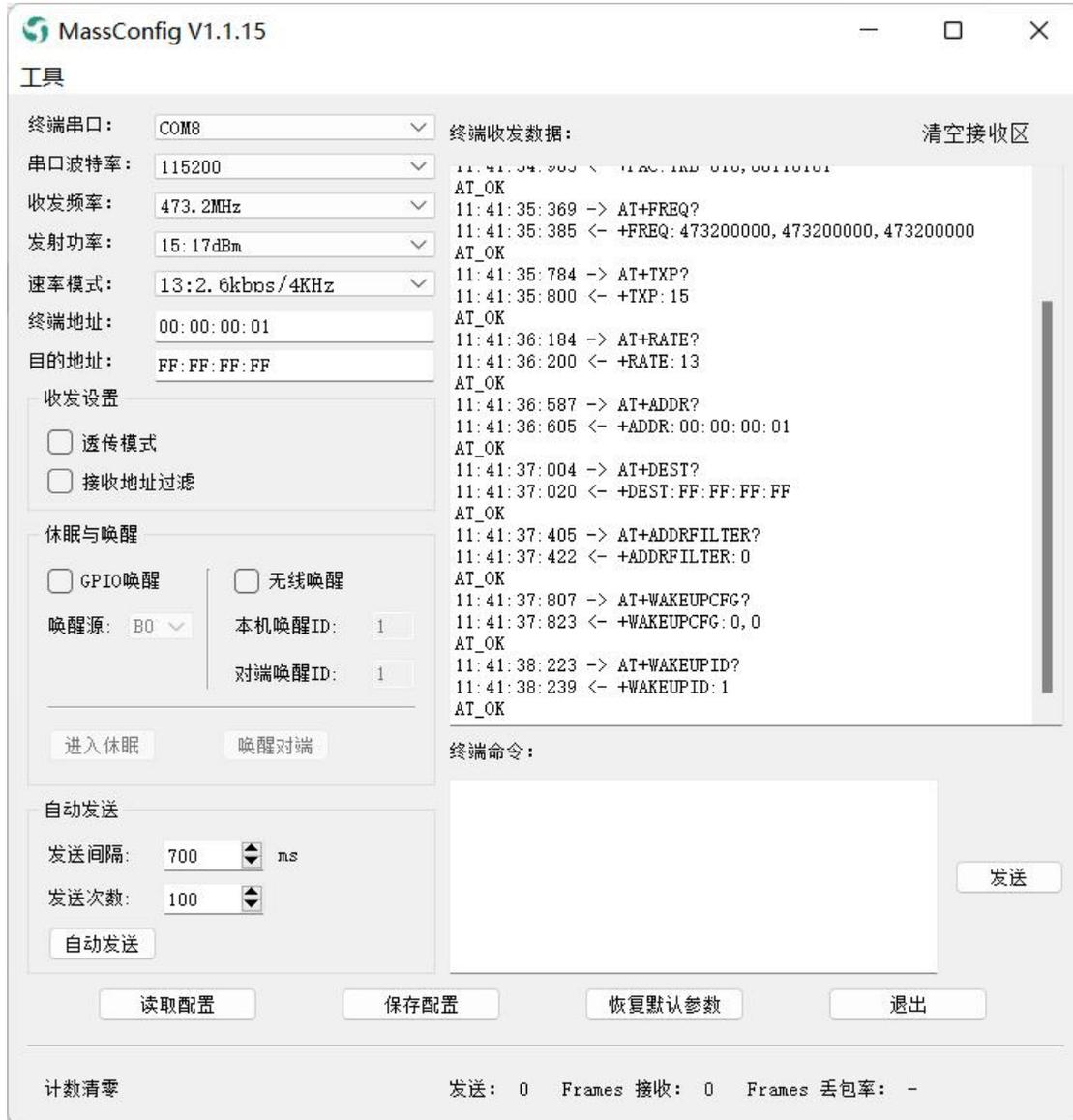
图 2-1 通讯测试-终端 A 配置页面
