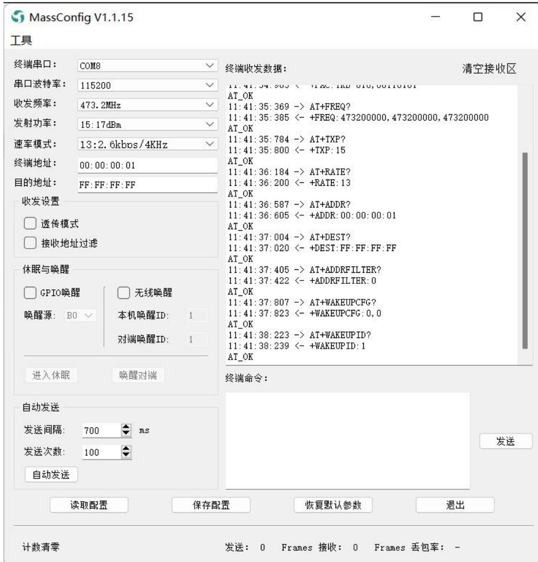
图 2-4 TK8610 开发板默认参数读取显示
