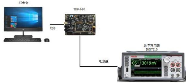
图 2-12 休眠电流测试-设备连接示意图
