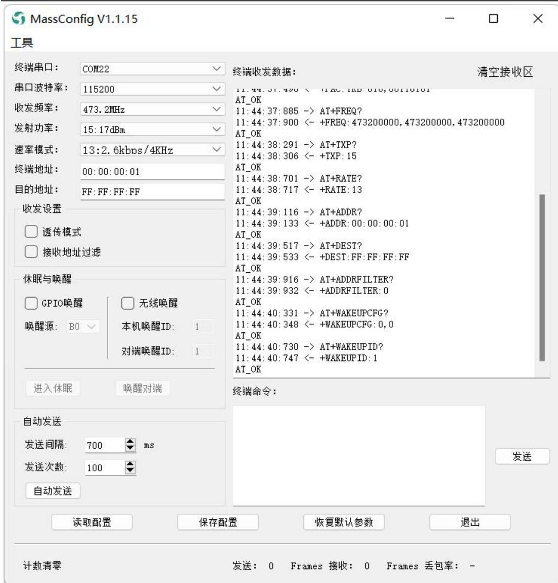
图 2-2 通讯测试-终端 B 配置页面
