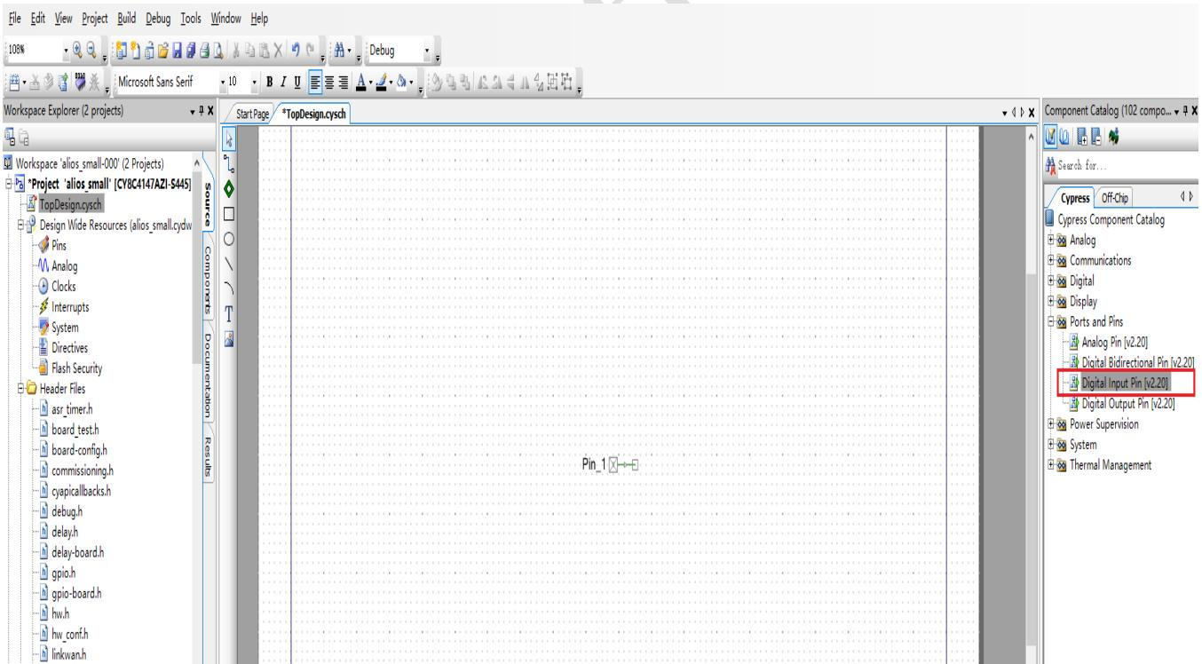
另外在 Pins 配置界面中可以配置 GPIO 的 PIN 脚，如下图中双击最左侧的红色部分，会出现界面最右侧配置部分。点击右侧红色标记的倒三角可以选择 PIN 脚。
