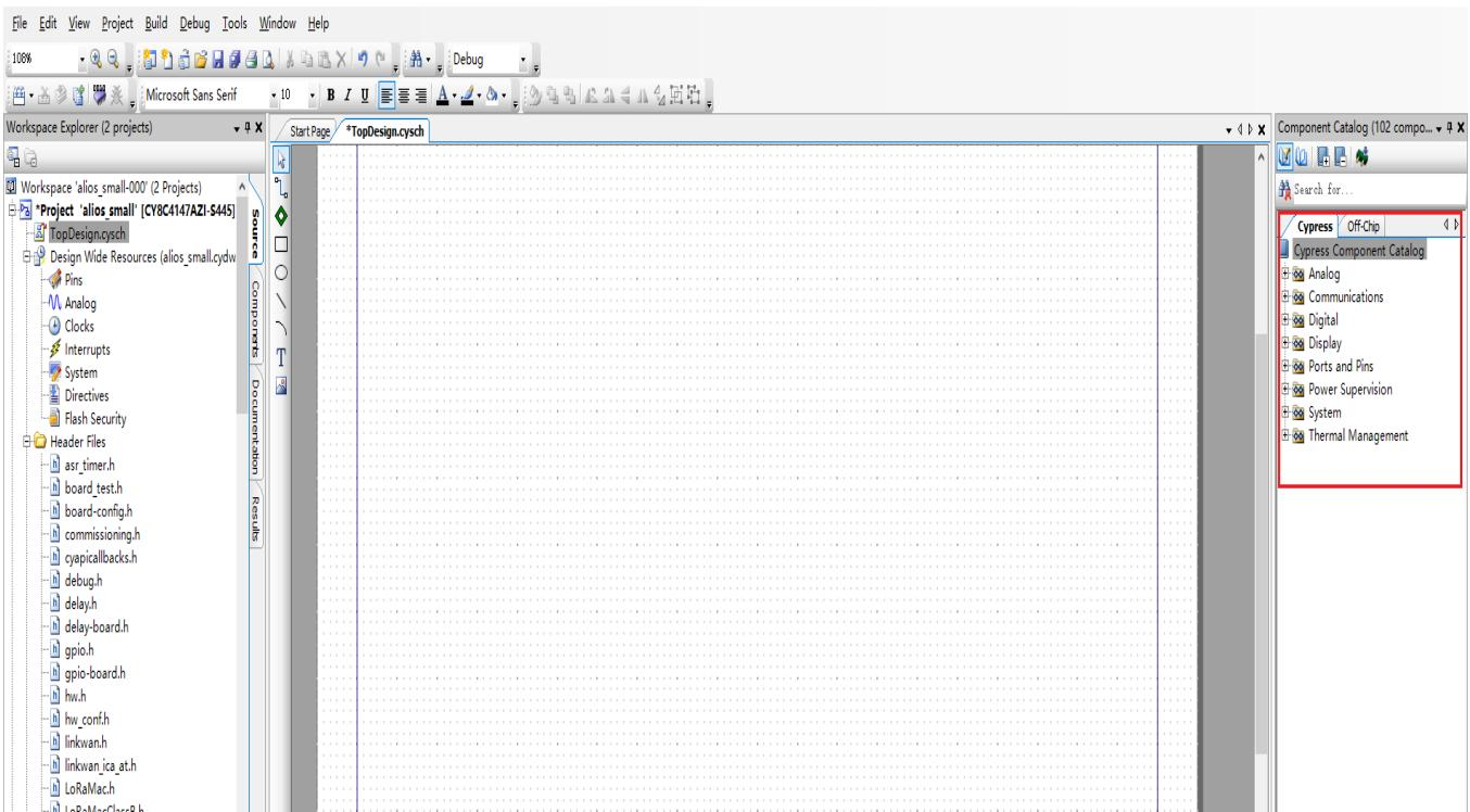
以 GPIO 类型为 Digital Input Pin 为例，点击下图中红色部分，按下左键后拖拽到软件界面中间部分。然后双击图标可以配置 Drive mode 和 Interrupt，以及可以更改名称。
