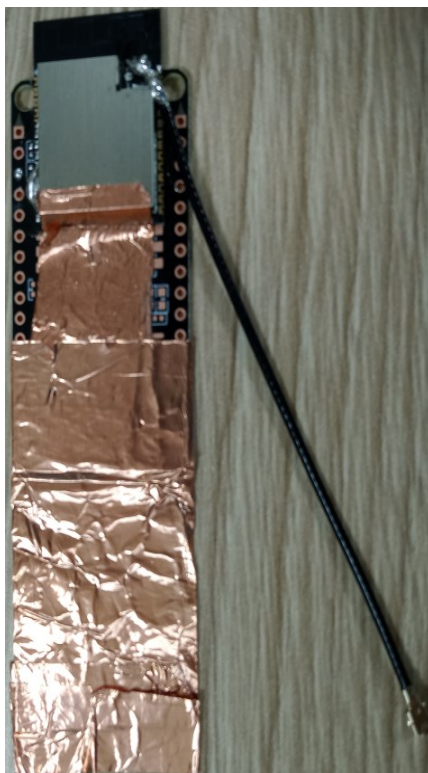
图 8 模拟用户将模组焊接到主板上的使用示意图
