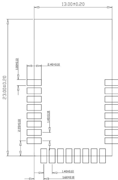
图 10 推荐 PCB 封装尺寸
