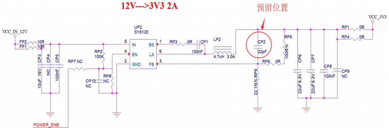
图 11 DC-DC 降压电路图
