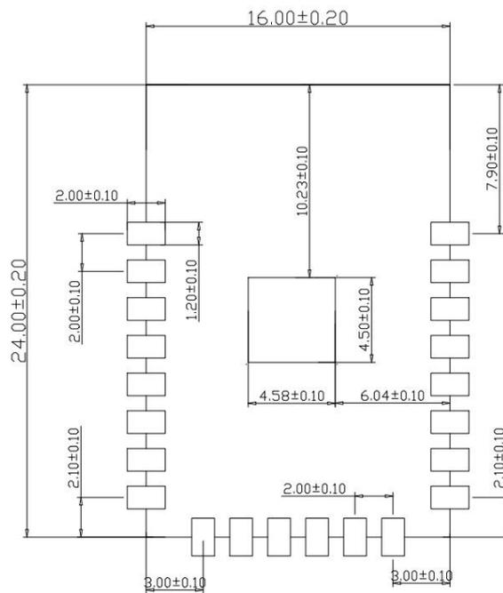
图 9 推荐 PCB 封装尺寸 (TOP 视图)
