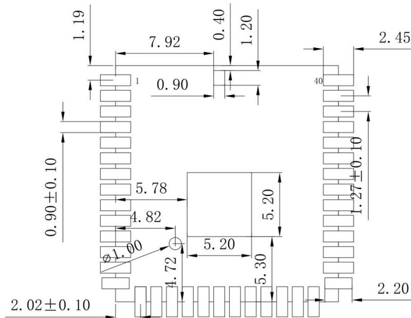
图 9 推荐 PCB 封装尺寸
