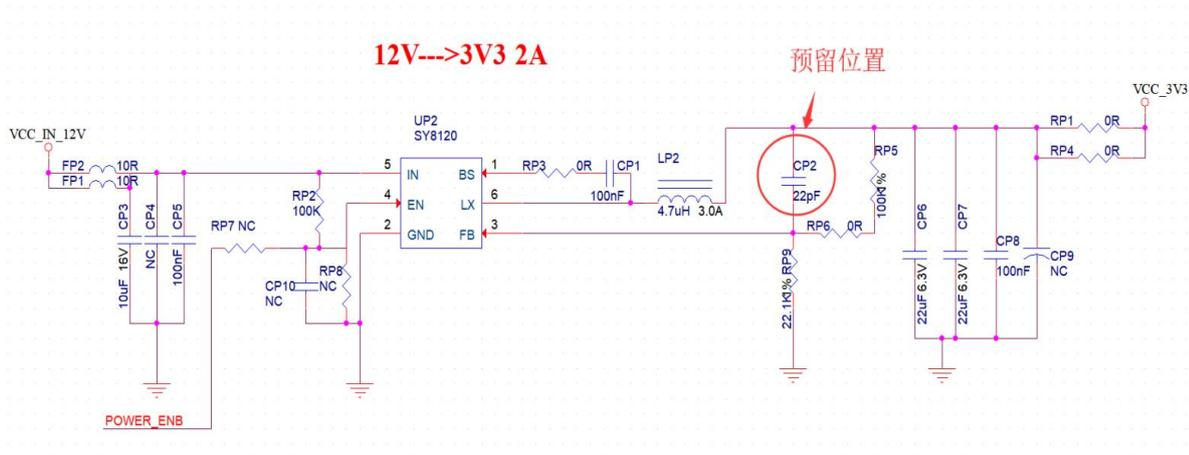
图 11 DC-DC 降压电路图
