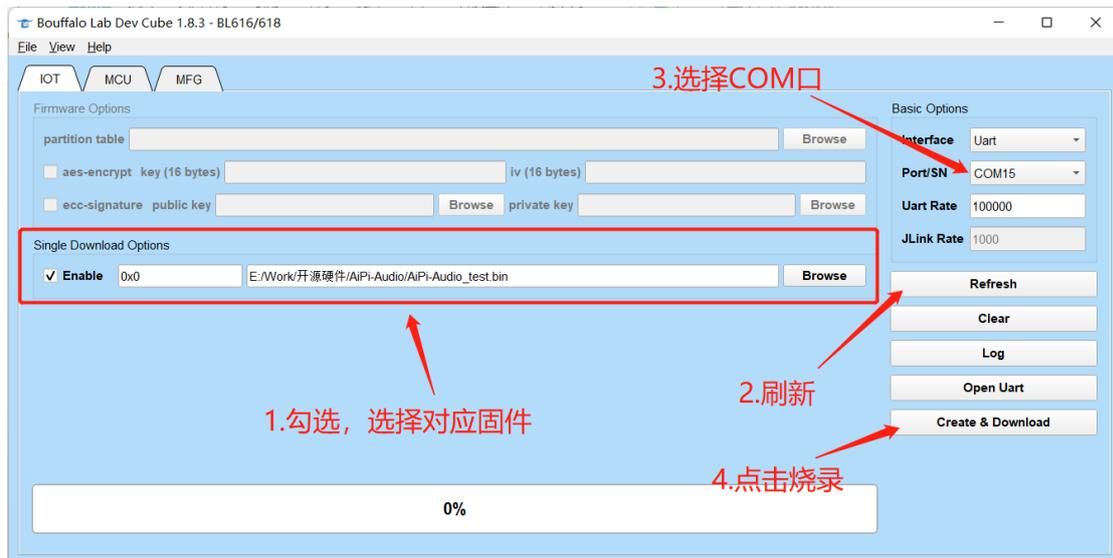
烧录工具在烧录开始后，按住“下载按钮”开始烧录后，才能松开。
